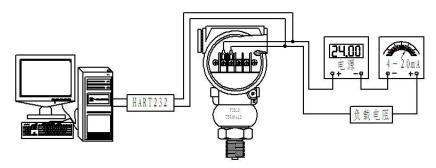
(4) HART 协议型变送器与手操器连接方法:
