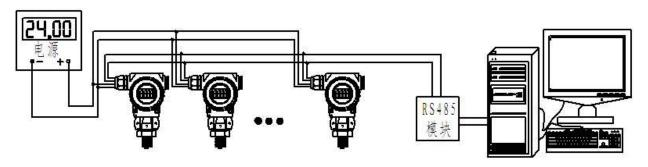
(3) HART 协议型变送器组态系统连接方法:
